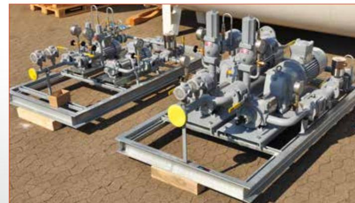
► Groupe de pompage avec pompe modèle Z2000 conformément aux spécifications client
